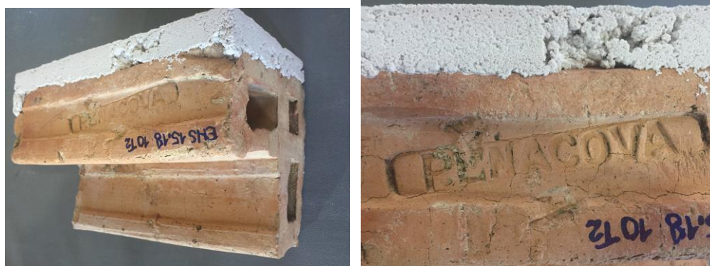
Figura 6 - Bloco cerâmico com identificação do fabricante.
