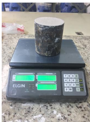
Figura 15 - Ensaio de densidade de massa no estado plástico.
