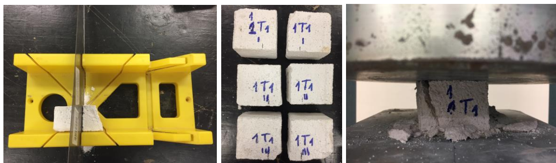
Figura 19 - Ensaio de resistência à compressão axial.
