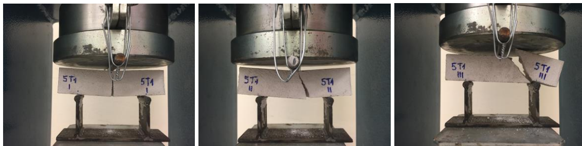
Figura 18 - Ensaio de resistência à tração na flexão.
