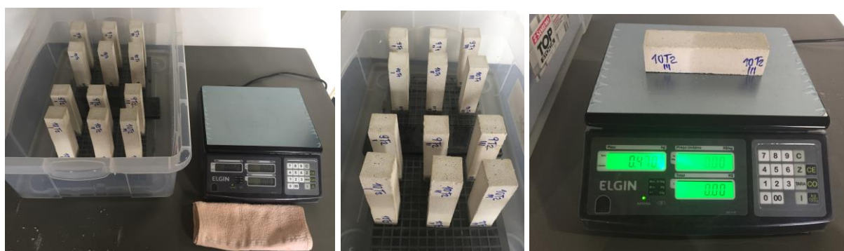
Figura 20 - Determinação da absorção de água por capilaridade e do coeficiente de capilaridade.
