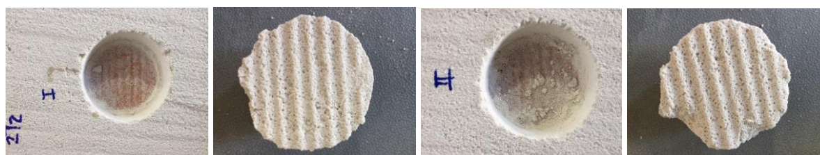
Figura 30 – Configuração de ruptura das argamassas.
