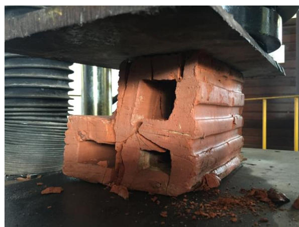
Figura 28 - Ensaio de resistência à compressão dos blocos em “L”.
