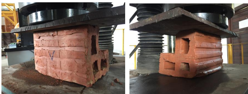
Figura 13 – Ensaio de caracterização mecânica dos blocos em “L”.
