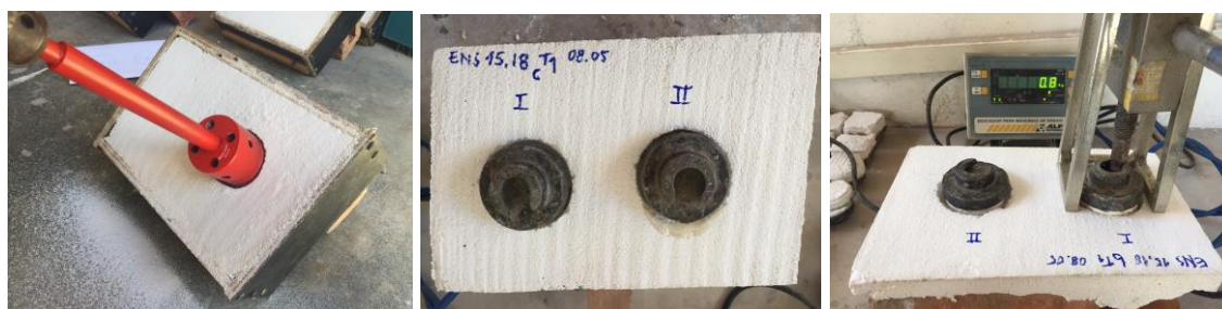
Figura 23 - Procedimentos de ensaio de resistência de aderência à tração.
