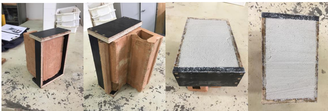
Figura 22- Bloco cerâmico com aplicação de gabarito e de argamassa de revestimento.
