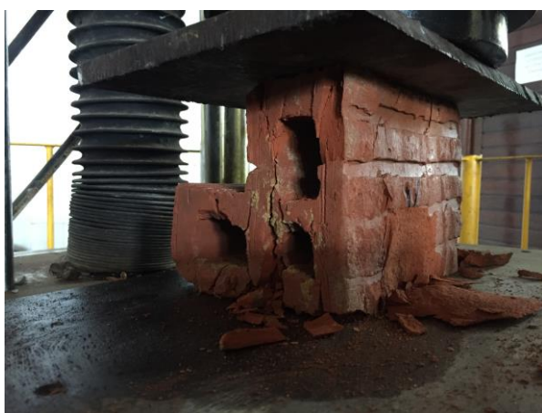
Figura 28 - Ensaio de resistência à compressão dos blocos em “L”.
