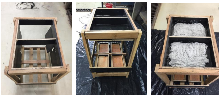
Figura 21 - Dispositivo mecânico, caixa de queda, para aplicação da argamassa no substrato.
